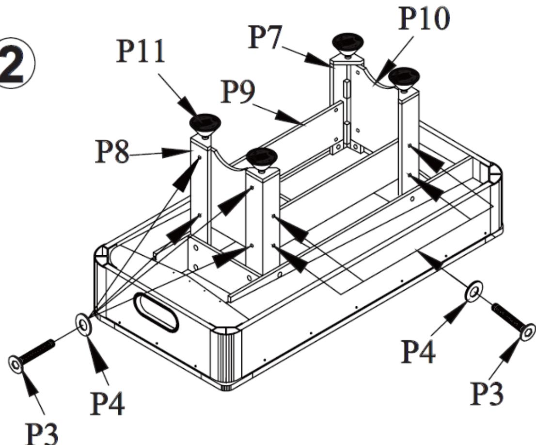
Přišroubujte čelní krycí panely nohou (P10) a stranové krycí panely nohou (P9) na vnitřní stranu nohou (P7 a P8) pomocí šroubů (P3) a podložek pod šrouby (P4).
